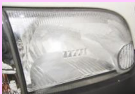
内部リフレクタの劣化
